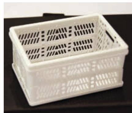
Miniatur-Klappkiste einschließlich Funktion aus 3D-Druckproduktion
